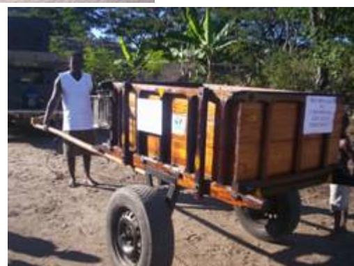
Charrettes à roues pneumatiques vulgarisées par ASA Miaro pour éviter l'usure rapide de la RN6 qui vient d'être réhabilitée
